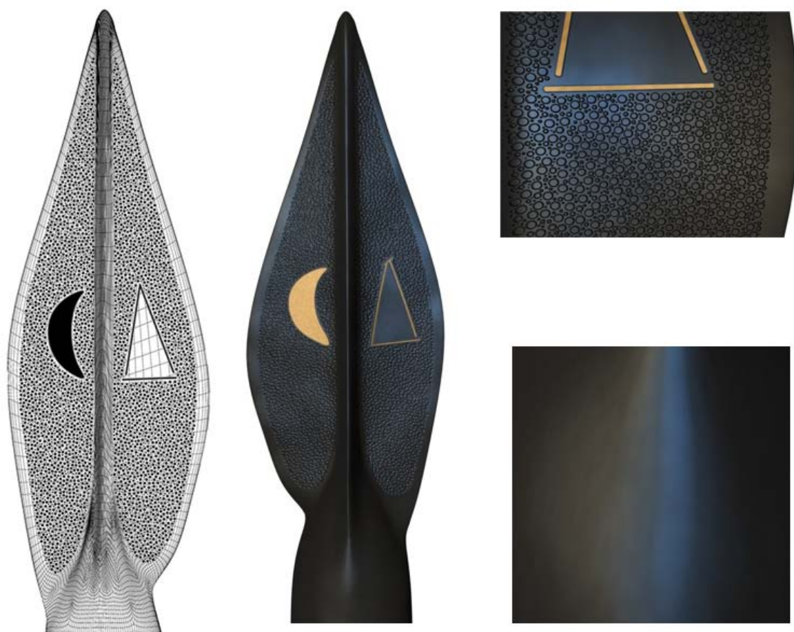
Rys. 5.4. Od lewej: siatka modelu z naniesionymi zgodnie z mapowaniem UV teksturami zdobień, model po nałożeniu wszystkich tekstur, zbliżenia na zdobienia (u góry) i na dwukolorowy odbłask (na dole)
